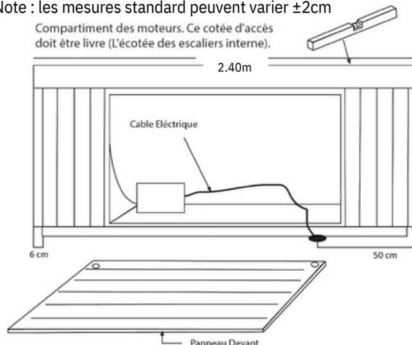
**IMPORTANT:** Le matériel doit être connecté à une ligne de tension exclusive et permanente, capable de supporter la puissance installée. Tous les appareils électriques et de lumière électrique doivent être localisé plus que 1,5 mètres de la Spa. Le circuit de terre doit être capable d'assurer la sécurité du matériel. L'installation électrique doit être selon la législation actuelle.
