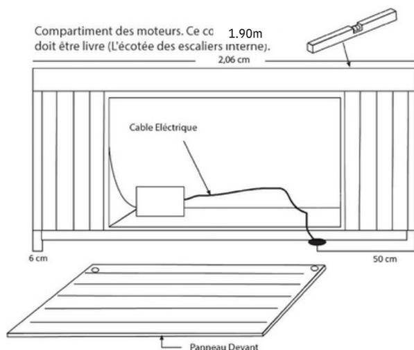
**IMPORTANT:** Le matériel doit être connecté à une ligne de tension exclusive et permanente, capable de supporter la puissance installée. Tous les appareils électriques et de lumière électrique doivent être localisés plus que 1,5 mètres de la Spa. Le circuit de terre doit être capable d'assurer la sécurité du matériel. L'installation électrique doit être selon la législation actuelle.
