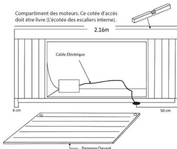
**IMPORTANT:** Le matériel doit être connecté à une ligne de tension exclusive et permanente, capable de supporter la puissance installée. Tous les appareils électriques et de lumière électrique doivent être localisé plus que 1,5 mètres de la Spa. Le circuit de terre doit être capable d'assurer la sécurité du matériel. L'installation électrique doit être selon la législation actuelle.
