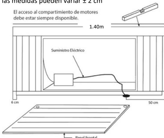
**IMPORTANTE:** El equipamiento debe estar conectado de forma permanente a una instalación fija capaz de soportar la potencia instalada. La instalación debe tener un dispositivo de corte omnipolar con separación de los contactos de por lo menos 3mm, y una ligación tierra con un diferencial de por lo menos 30mA de sensibilidad. El Spa debe estar, en todas las instalaciones, a 1.5m de distancia de todas las salidas y dispositivos permanentemente conectados al suministro eléctrico.
