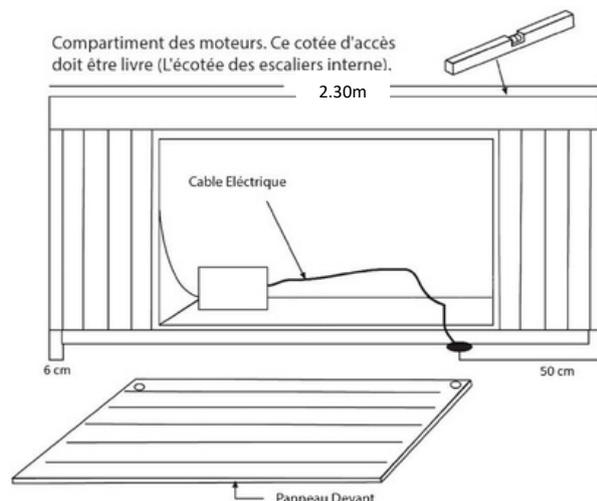
**IMPORTANT:** Le matériel doit être connecté à une ligne de tension exclusive et permanente, capable de supporter la puissance installée. Tous les appareils électriques et de lumière électrique doivent être localisés plus que 1,5 mètres de la Spa. Le circuit de terre doit être capable d'assurer la sécurité du matériel. L'installation électrique doit être selon la législation actuelle.
